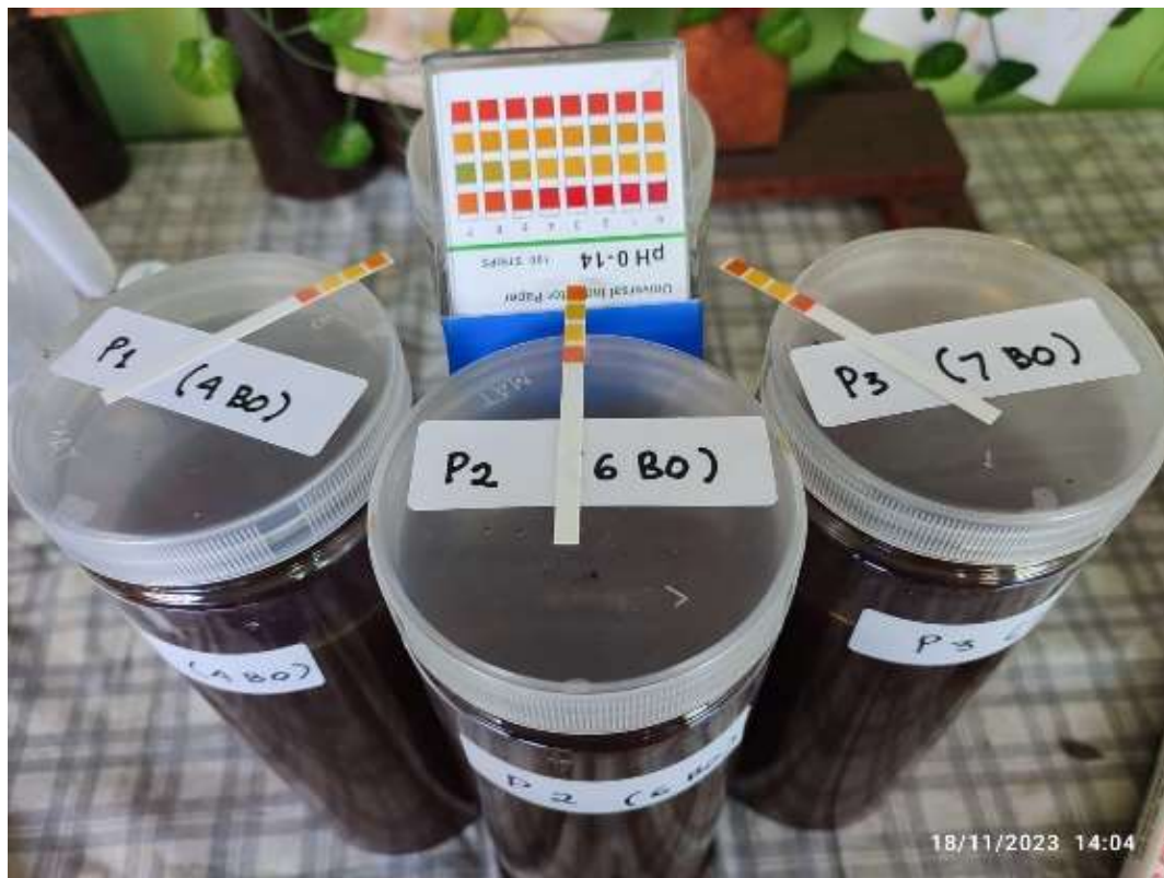
Gambar 2. Pengukuran pH ekoenzim pada akhir pengamatan menggunakan kertas indikator pH.
